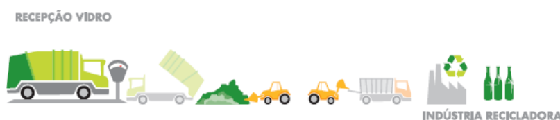
Figura 5 – Esquema do processo do vidro proveniente da recolha selectiva
