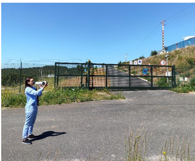
Figura 4 – Exemplo de medição com olfatómetro portátil Nasal Ranger
