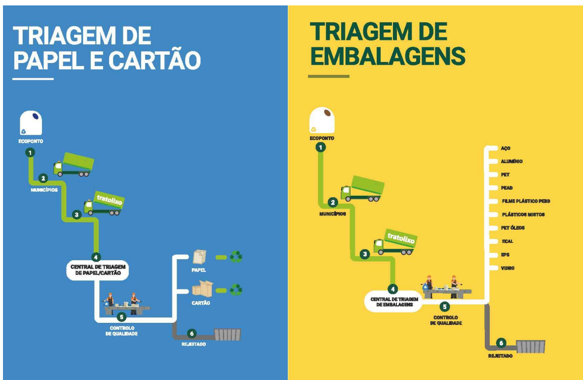
Representação esquemática do funcionamento da triagem de papel/cartão e embalagens de plástico, metal e ECAL na CT de Trajouce.
